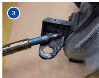
溶着ピンの足を切り落とし、ハンダごてで熱を加えて接合部の形状を整える
