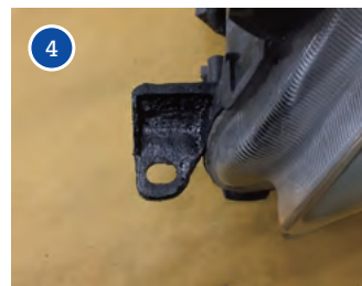
接合部の形状を整えた後、ベルトサンダ、ヤスリで表面や取付穴を整え塗装を行う
