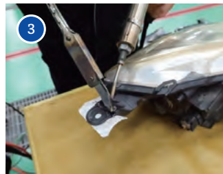
3 樹脂を溶かし込んだ部分に窒素を吹き付け、ハンダごてで整形する
