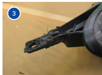
瞬間接着剤で折損した部位を保持、 樹脂補修用接着剤を塗布し研磨して整形
