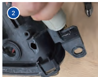
溶着ピン折損した部分に埋め込む
