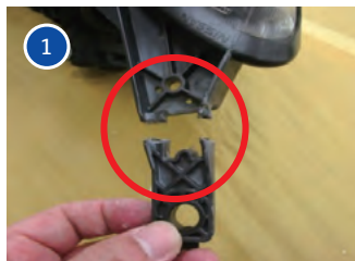
ヘッドランプブラケットの折損。 この車両は補修用ブラケットの設定なし
