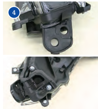
補修用ヘッドランプブラケットをビスで取付ける
