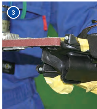
折損した部位をカッター、ベルトサンダー等で整える
