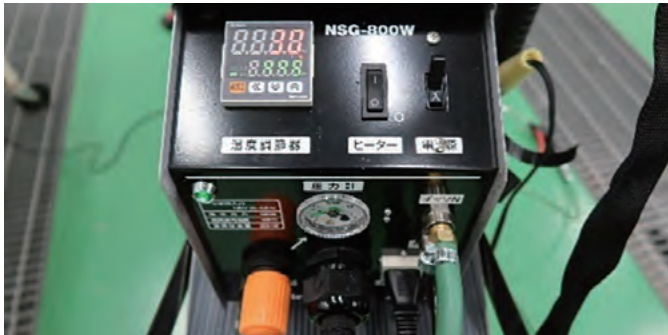
溶接機本体 吐出温度をデジタル制御
