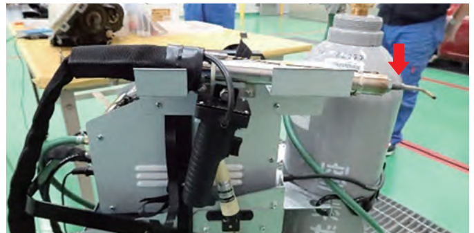
トーチハンドル 先端から窒素および熱風が噴出
