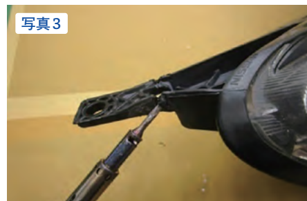
ハンダごてによる形状の修正 裂け目を溶かしながら接合するイメージで形状を整える
