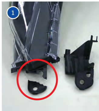
ヘッドランプブラケットの折損
