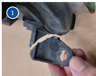
ヘッドランプブラケットの折損
