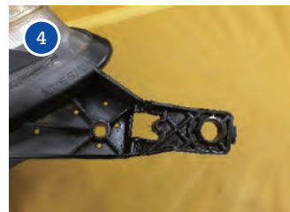
接着剤をベルトサンダ等で研磨し、 形状を整えた後、塗装を行う
