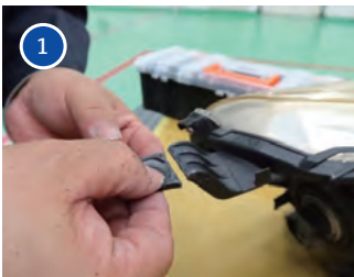
1 ヘッドランプブラケットの折損
