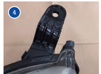
4 整形後に冷却し、ベルトサンダ等で表面を整え塗装を行う
