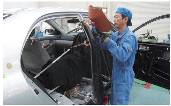
カローラ120系 ボデー修理書には、切り継ぎ取替の指示があります。
