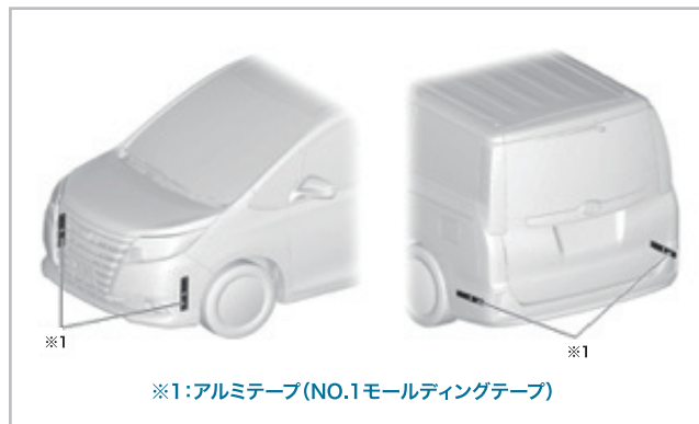
※1:アルミテープ(NO.1モールディングテープ) フロントおよびリヤバンパーカバーの裏面に貼付 新品のバンパーには貼付されていないので、貼付し忘れにご注意を
