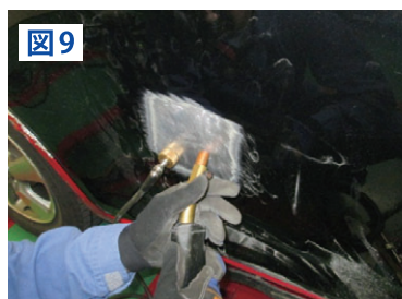
低温・短時間加熱で絞り作業を行う。
