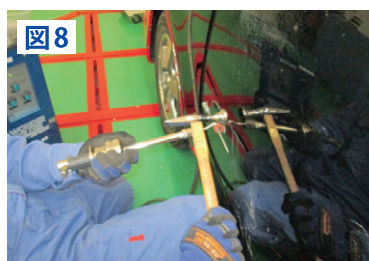
【引き出し作業】 ワッシャー数枚を同時に引きながら周囲をハンマリングし、損傷部を修正します。
