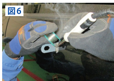
ハンダによるプルプレート溶着
