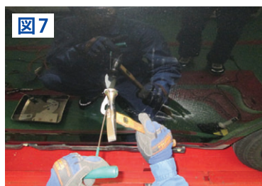
【引き出し作業】 プルプレートを引きながら周囲をハンマリングし、損傷部を修正します。
