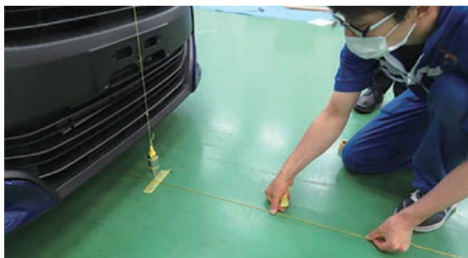
①糸と錘を使用して床面に設置点をマーキング。
