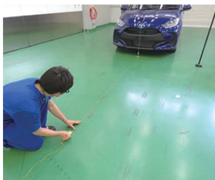
① 糸と錘で設置点を床面にマーキングする。
