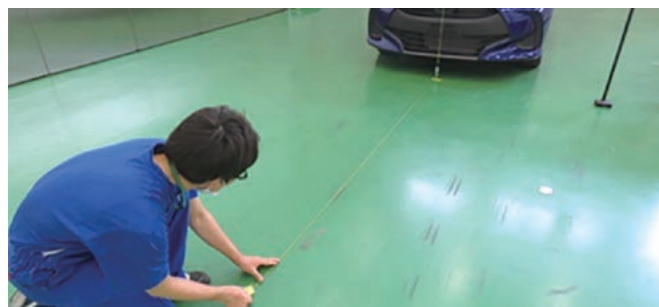
① 錘と糸で車両中心線を前方に伸ばします。
