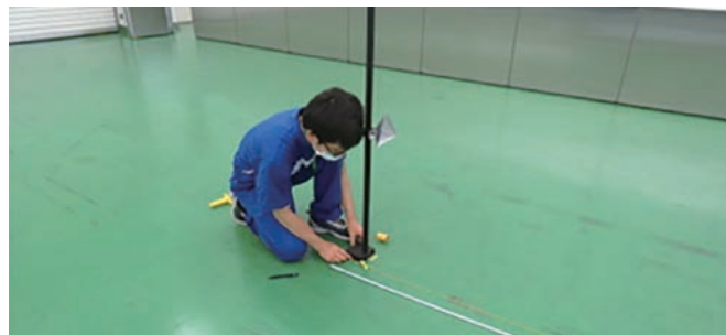
③ バンパ先端から3000mmにターゲットを設置。
