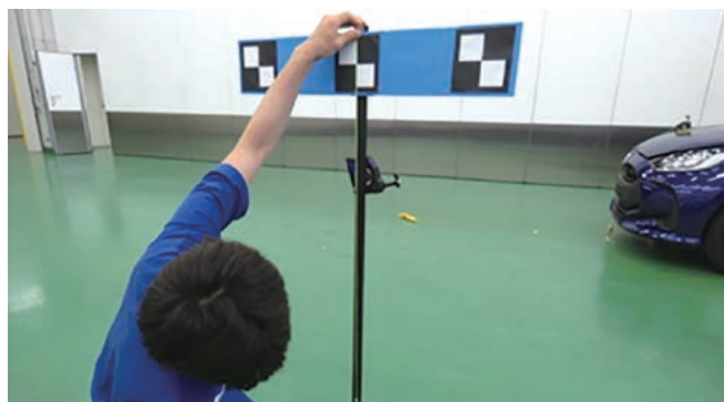
②ターゲット※を指定高さに調整する。
