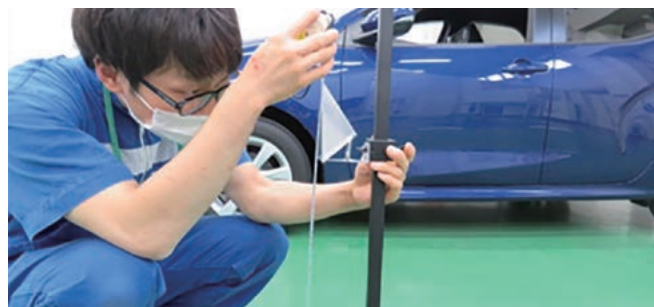
② ターゲットを指定の高さに調整します。
