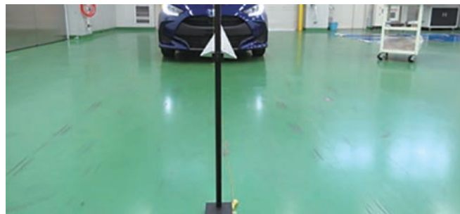
④ 診断機を操作してエーミングを実施します。
