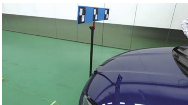
②ターゲット※を指定高さに調整する。
