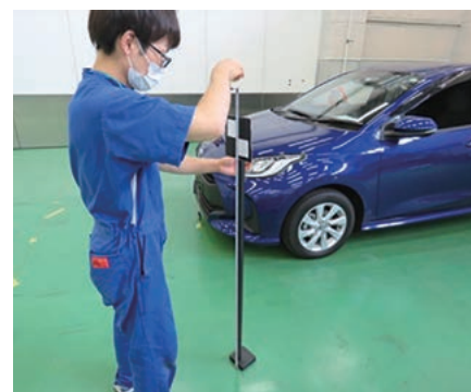
② ターゲットを指定高さに調整する。
