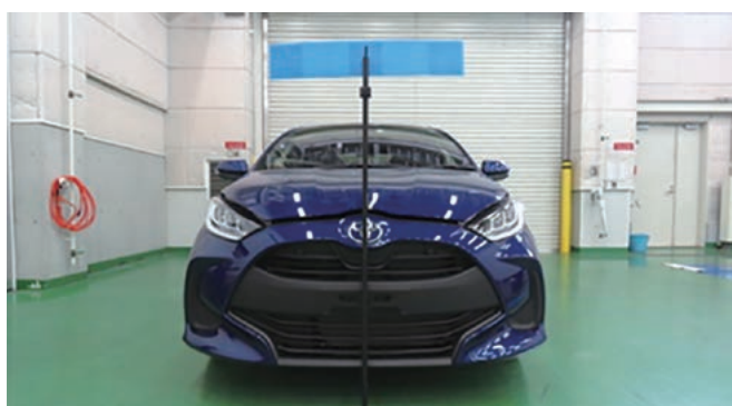
③設置位置（バンパ前端中央部）にターゲットを設置し、診断機でターゲットを認識させます。
