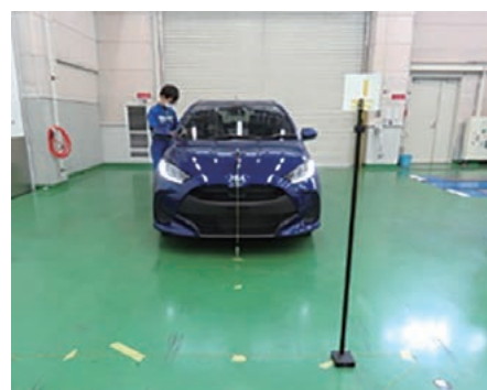
② ターゲットを指定高さに調整する。
