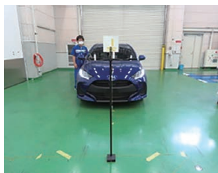
③ 診断機を接続し、指示に従ってターゲットを中央と左右の3カ所で順次認識させる。
