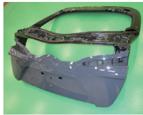
例：トヨタプリウスPHVの補給形態（下色塗装で補給）
