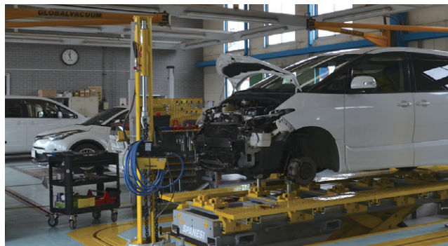
工場内部に設置されたフレーム修正機
